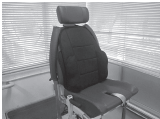
図2 被験者の背中と背もたれの間に挟み込んだシート
